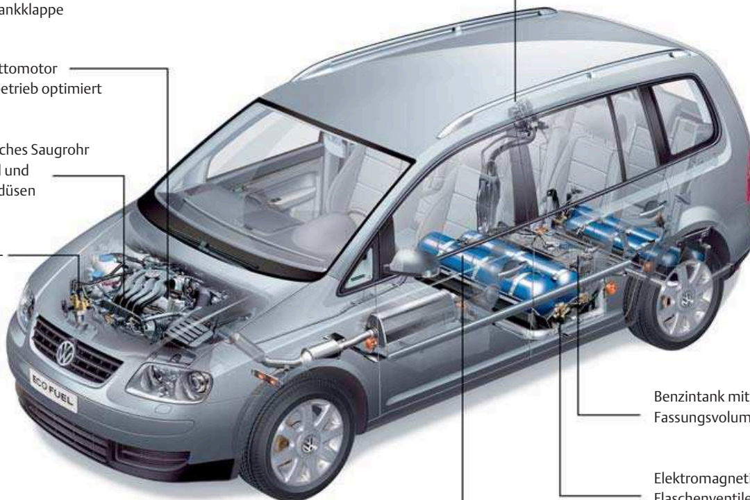
Einbaubeispiel Touran 2.0 EcoFuel, werkseitig (Foto: Volkswagen AG)
